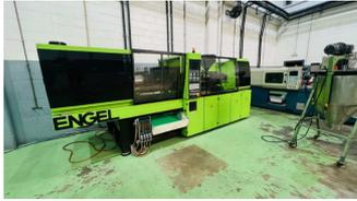
**Inyectora termoplástico 120 ton.**
