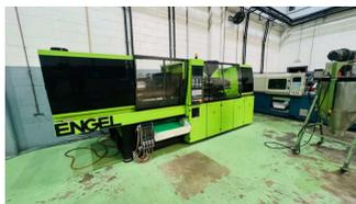
**Inyectora termoplástico 120 ton.**
