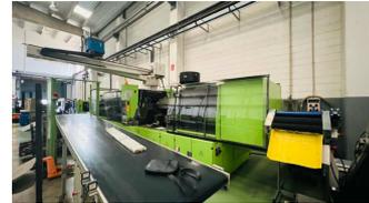
**Inyectora termoplástico 350 ton ,con robot**
