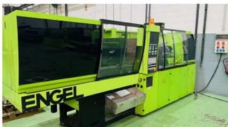
**Inyectora termoplástico 110 ton.**
