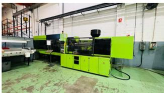
**Inyectora termoplástico 275 ton.**
