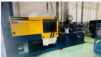
**Inyectora termoplástico 135 ton.**
