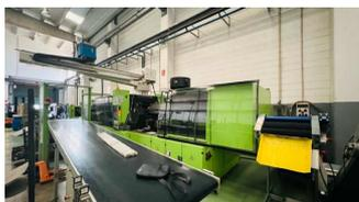
**Inyectora termoplástico 350 ton ,con robot**
