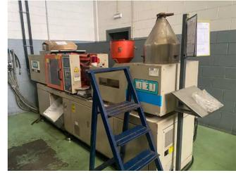
**Inyectora termoplástico 80 ton.**
